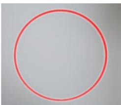
Vollständiger roter Kreis: Die Messung entspricht nicht den eingestellten Schwellenwerten, das Kabel hat den Test nicht bestanden.
